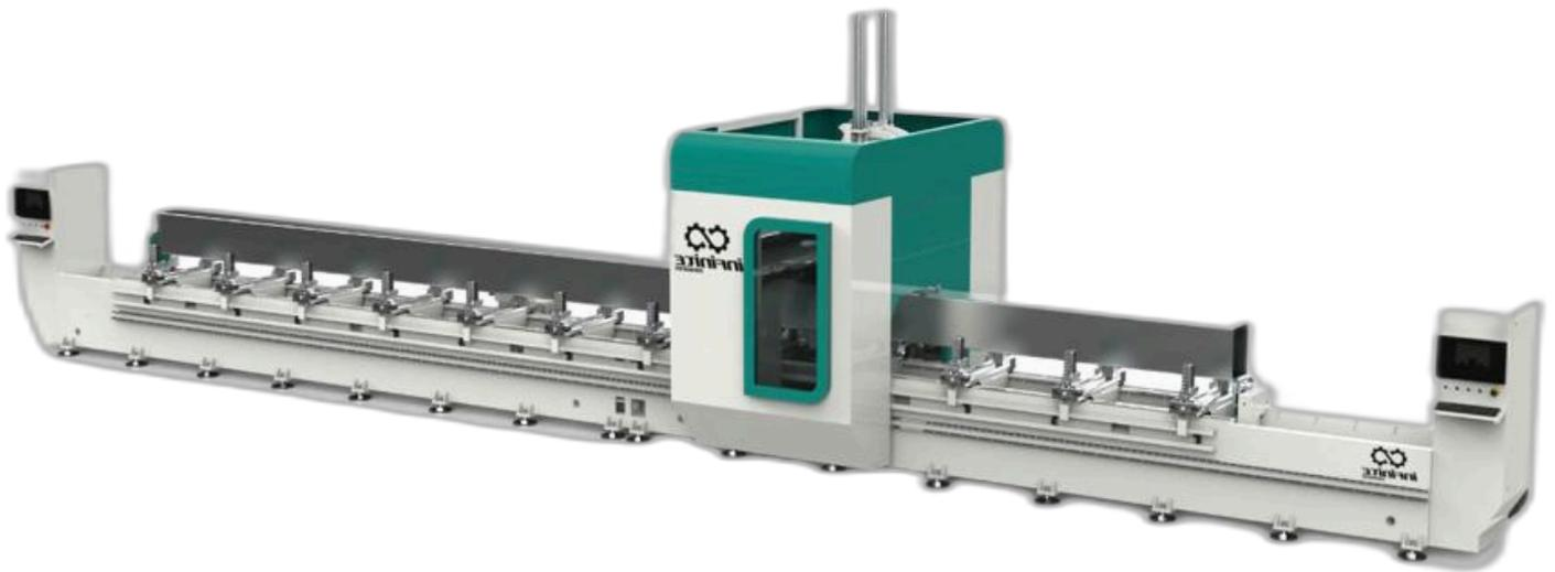
Während sich die Maschine im Parkmodus befindet, werden die Spannzangen in die offene Position gebracht. Das zu ladende Profil sollte sich an die feste Vorderseite der Spannzange anlehnen. Anschließend ermöglicht die Maschine das Arbeiten, indem sie die gewünschte Datei aus dem CAM-Programm sendet.
